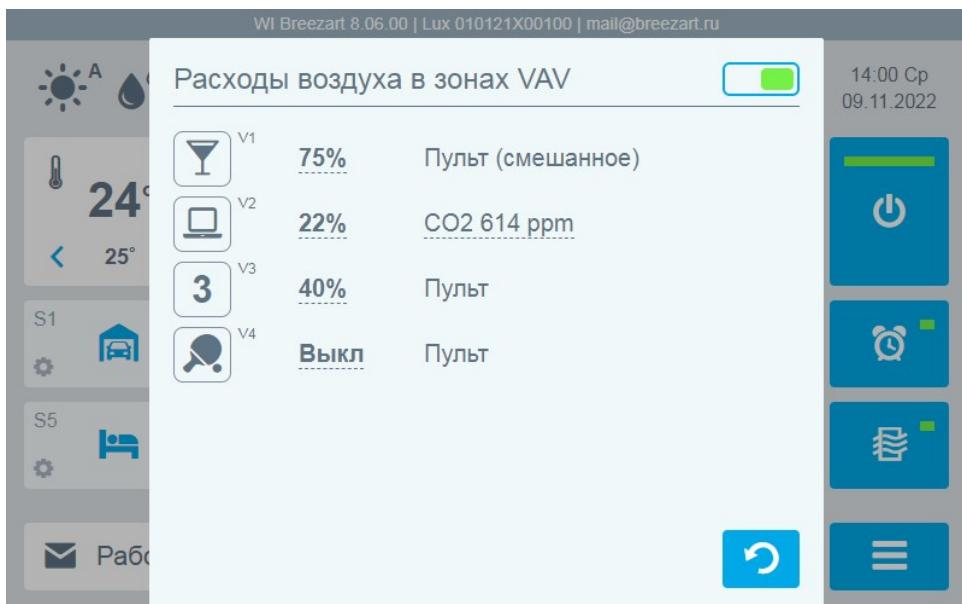
Переключатель в правом верхнем углу позволяет временно отключать VAV систему. При отключении все зоны полностью открываются, управление вентилятором переходит в ручной режим (как при отсутствии VAV).
