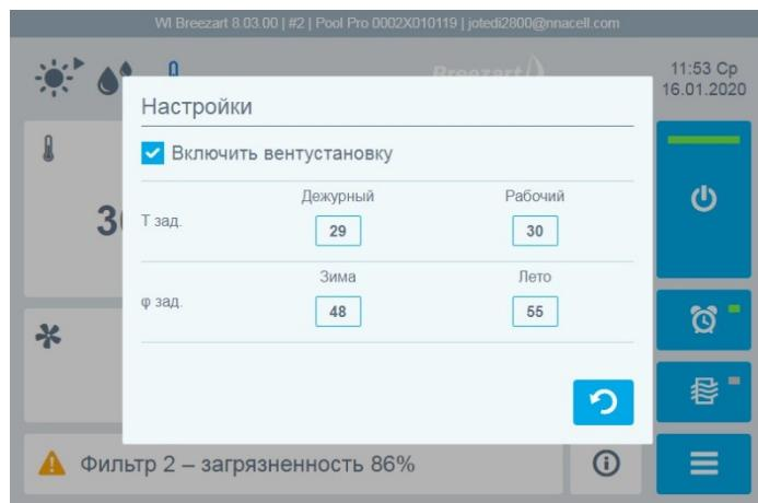
Кнопка **Информация**, расположенная в нижней части Главного экрана, позволяет просматривать информацию о вентустановке, показания датчиков и состояние ее компонентов.
