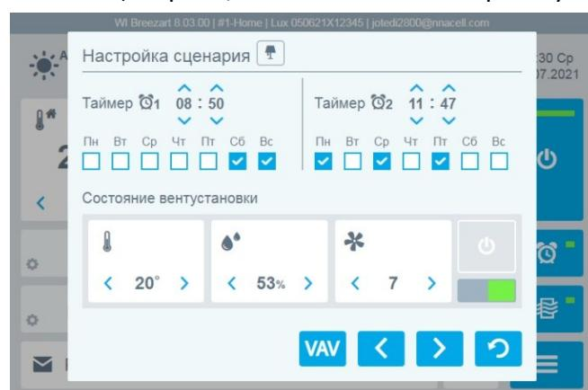
При нажатии на кнопку **Информация**, расположенную в правой нижней части Главного экрана, откроется окно с информацией о вентустановке. Для просмотра датчиков нажмите на кнопку **>**.
