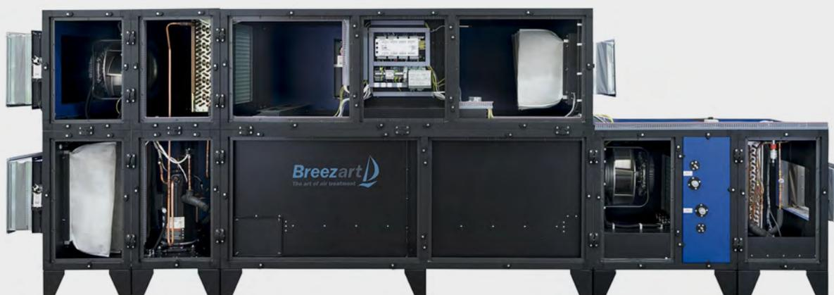
Приточно-вытяжная установка с пластинчатым рекуператором, ЕС вентиляторами (работают в CAV режиме) и встроенной холодильной машиной переменной производительности на базе компрессора Digital Scroll.
